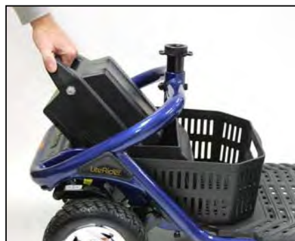
Imagen 21. Instalación de la batería
