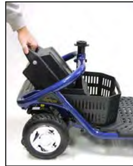
Imagen 14. Removiendo la batería
