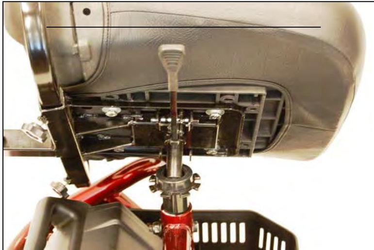
Imagen 23. Instalando el asiento
