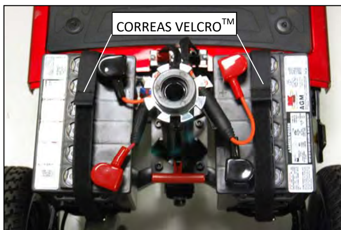
IMAGEN 23. INSTALACIÓN DE LAS BATERÍAS
