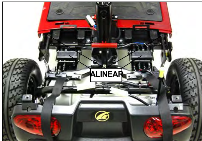
IMAGEN 21. CORREGIR LA ALINEACIÓN DEL MARCO
