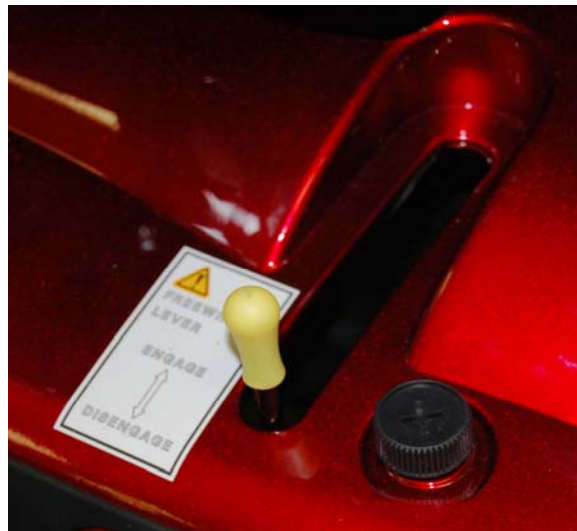
IMAGEN 12. PALANCA RUEDA LIBRE (DESACTIVADA)
